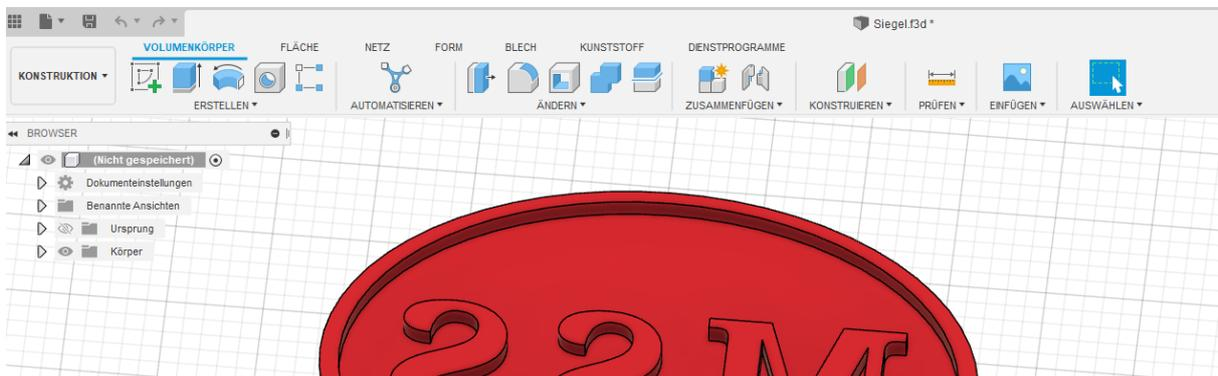
Sobald Sie Ihr Objekt in Fusion importiert haben(kann ein wenig dauern) kann dieses weiterbearbeitet werden. So bietet Tinkercad z.B. nicht die Möglichkeit Fasen abzunehmen oder Kanten abzurunden. In Fusion ist das einfach möglich.
